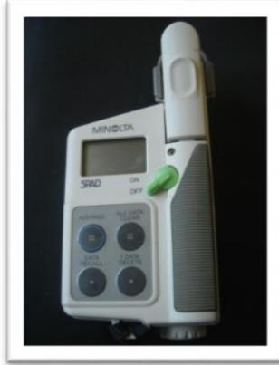
الشكل 11 :صورة تبين جهاز SPAD لقياس الكلوروفيل
